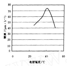
焦磷酸铜 85 g·L<sup>-1</sup>, 焦磷酸钾 320 g·L<sup>-1</sup>, 柠檬酸铵 20 g·L<sup>-1</sup>, 添加剂 40 m g·L<sup>-1</sup>, 电流密度 3 5 A·dm<sup>-2</sup>
