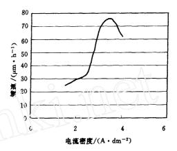
焦磷酸铜 85 g·L<sup>-1</sup>, 焦磷酸钾 320 g·L<sup>-1</sup>, 柠檬酸铵 20 g·L<sup>-1</sup>, 添加剂 40 m g·L<sup>-1</sup>, 温度 40
